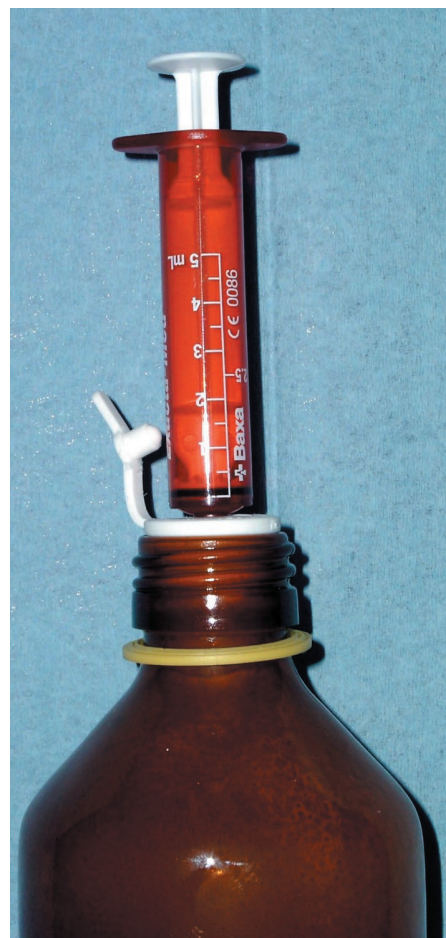
Abb. 1 Flasche mit Stopfen und aufgesetzter Spritze
